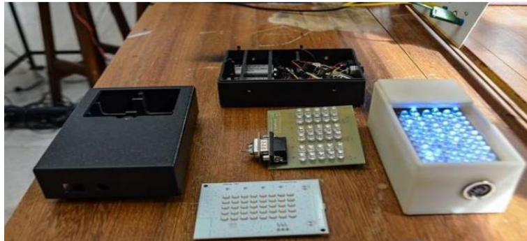
Figura 7-1. Placa de controle e uma placa de irradiação luminosa. Fonte: AC Silva – 2022
